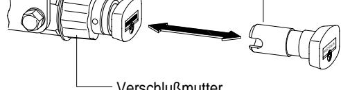
Sofern sich die Schenkelfeder **nicht vollständig** durch die Sicherungsbohrung stecken läßt, ist die Kugelstange nicht vorschriftsmäßig verriegelt und darf wegen der damit verbundenen Unfallgefahr unter keinen Umständen benutzt werden.
