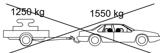
**Observer les directives dans la Notice d'utilisation du fabricant du véhicule en cas de déplacement avec une remorque ou une caravane.**
